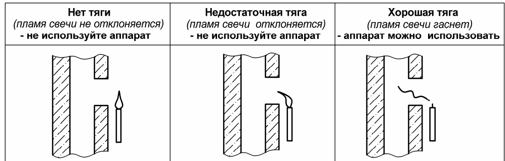
Рисунок 4. Способ проверки тяги в дымоходе
