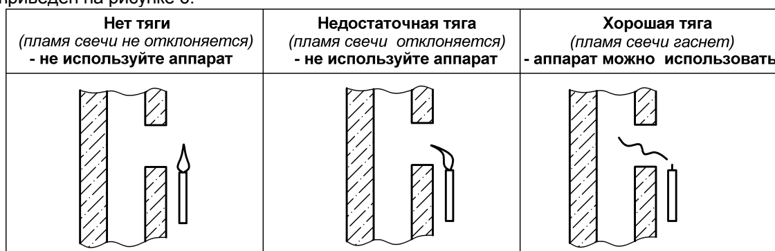
Рисунок 6. Способ проверки тяги в дымоходе
