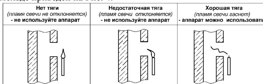
Рис. 4. Способ проверки тяги в дымоходе
