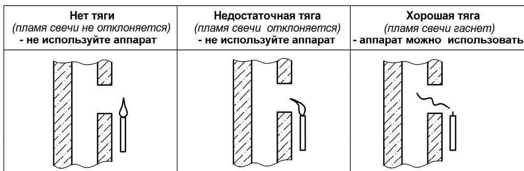
Рисунок 4. Способ проверки тяги в дымоходе
