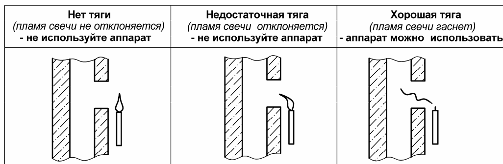
Рисунок 4. Способ проверки тяги в дымоходе
